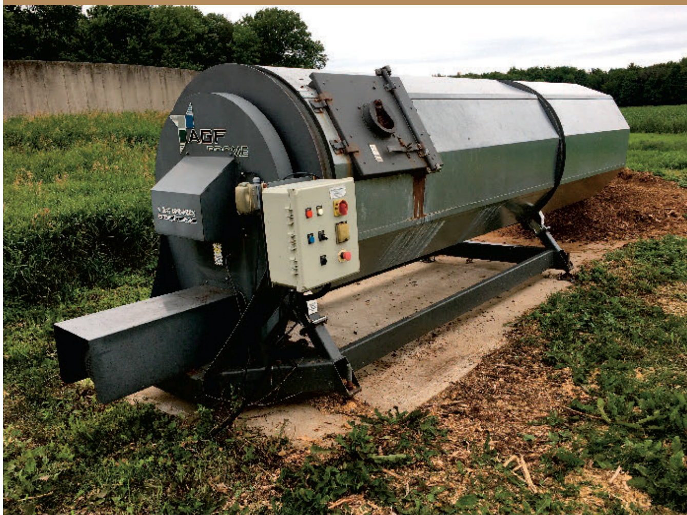
Le composteur a été installé sur une dalle de béton, loin d'un cours d'eau et près d'une source électrique.
