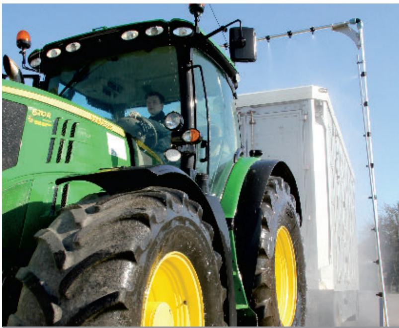
Afin de renforcer la biosécurité sur son exploitation, Frank Tiggemann a notamment installé des portiques de désinfection pour les véhicules.
