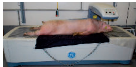
Numérisation d'un porcelet vivant permettant d'estimer le contenu en muscle (protéines), en gras (lipides) et en minéraux.
