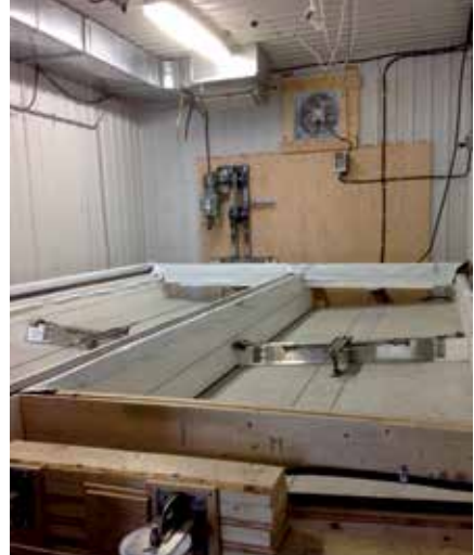
Système expérimental de grappe en V de l'IRDA pour la collecte séparée du liquide et du solide des lisiers en production porcine (voir « Séparation dans le bâtiment des fractions liquide/solide » au tableau 1).
